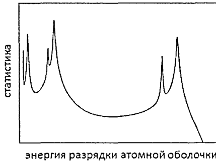
Рис. 8. Спектр полной энергии разрядки возбуждённой атомной оболочки дочернего нуклида электронного захвата. Пики соответствуют захвату электронов с различных атомных уровней. Ширина пиков определяется временем жизни возбуждённой атомной оболочки дочернего нуклида
