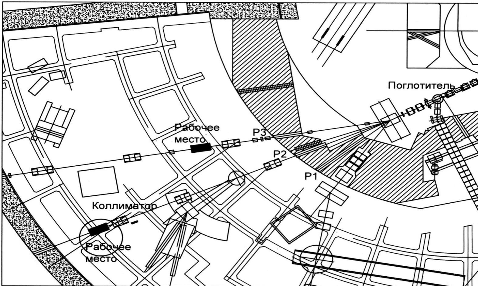
Экспериментальный стенд для испытаний ЭКБ на пучках протонов 50 – 900 МэВ
