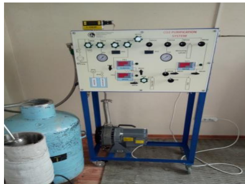
Установка по очистке \text{CO}_2
