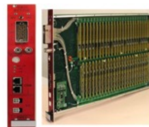
Модуль ASD16 - 16 канальный усилитель - дискриминатор
