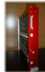
DB50 - 50-канальный модуль распределения высоковольтного питания системы HVDS
