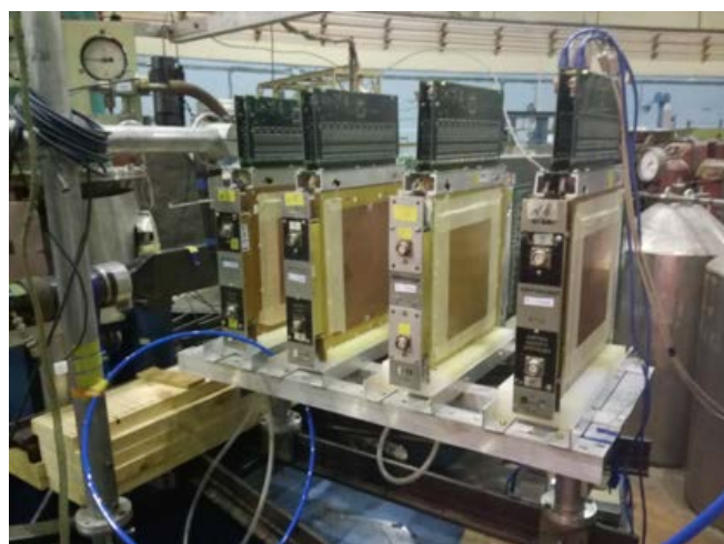
Пропорциональные камеры установленные на \pi -мезонном канале СЦ-1000
