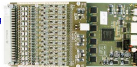
ASF48et - 48-канальная карта сбора аналоговой информации с навесным предусилителем, Flash ADC и программируемой FPGA -логикой
