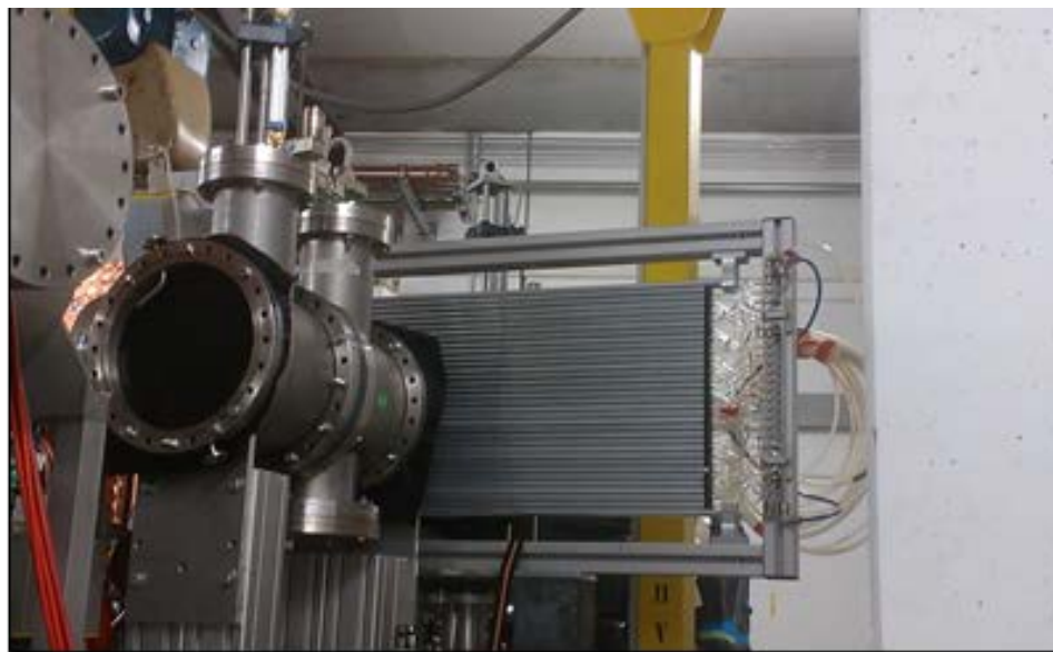
Рис. 3 Пучковые испытания PAS-прототипа в GSI
