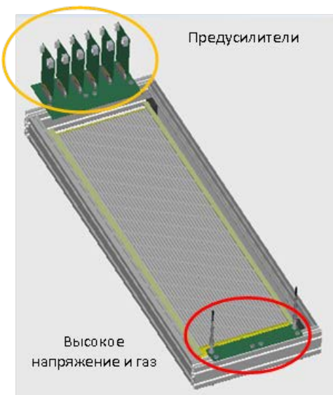
Рис. 2. Чертеж прототипа и структура размещения дрейфовых трубок.
