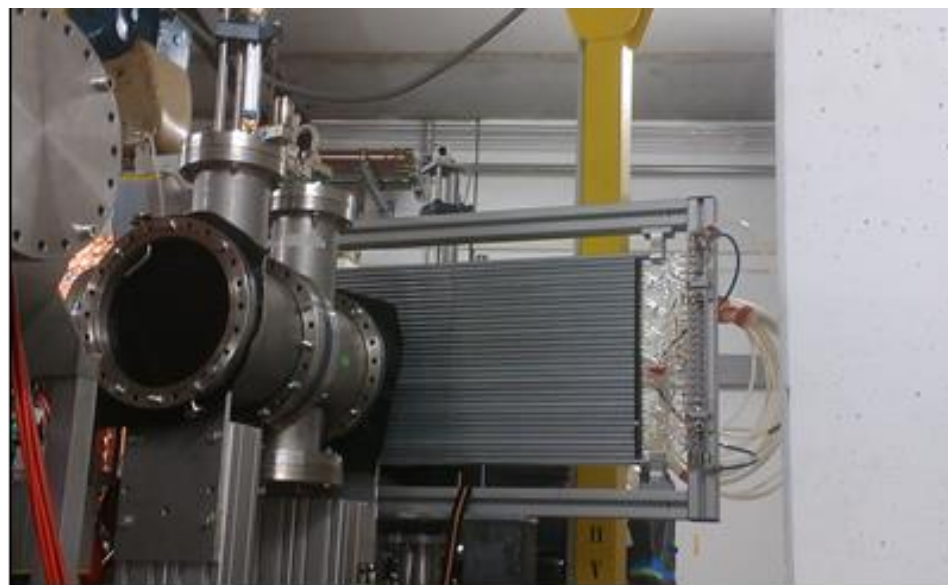
Рис. 3 Пучковые испытания PAS-прототипа в GSI
