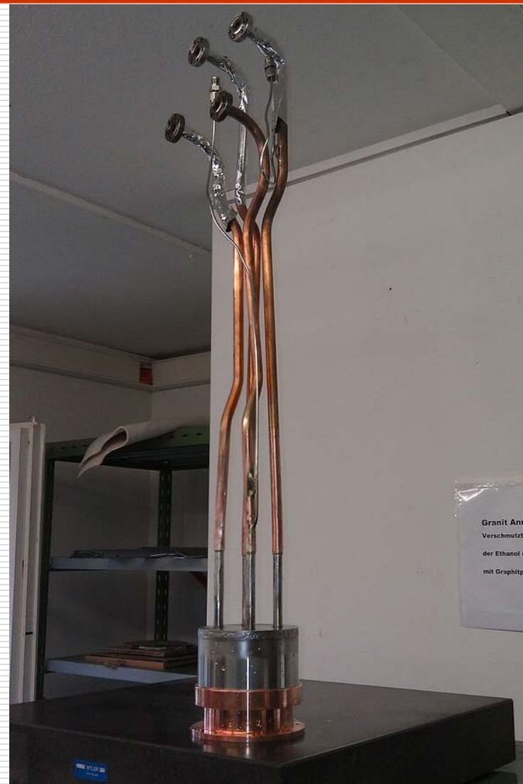
Нолвый блок системы неоновой тепловой трубы
