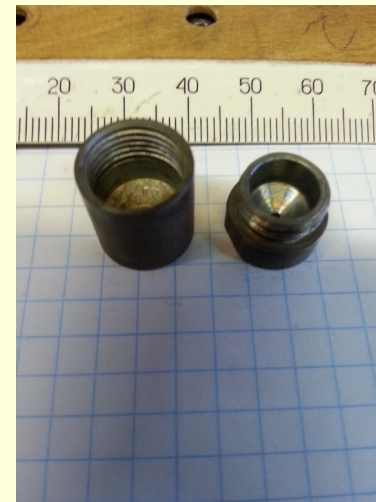
Капсула после полной возгонки мишенного вещества
