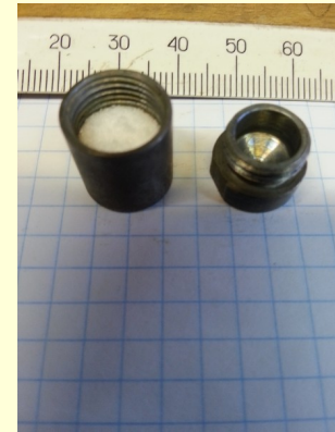
Капсула с мишенным веществом до и после нагрева при низкой температуре
