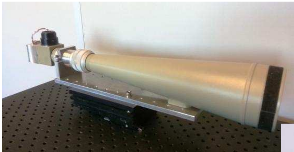
Оптический цифровой автоколлиматор повышенной чувствительности
