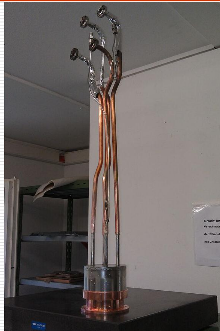
Нолвый блок системы неоновой тепловой трубы
