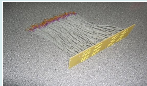
Разветвительная плата с высоковольтными изолированными проводами
