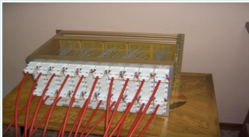
Модуль соединительной панели: 10 разветвительных плат 100 высоковольтных разъёмов
