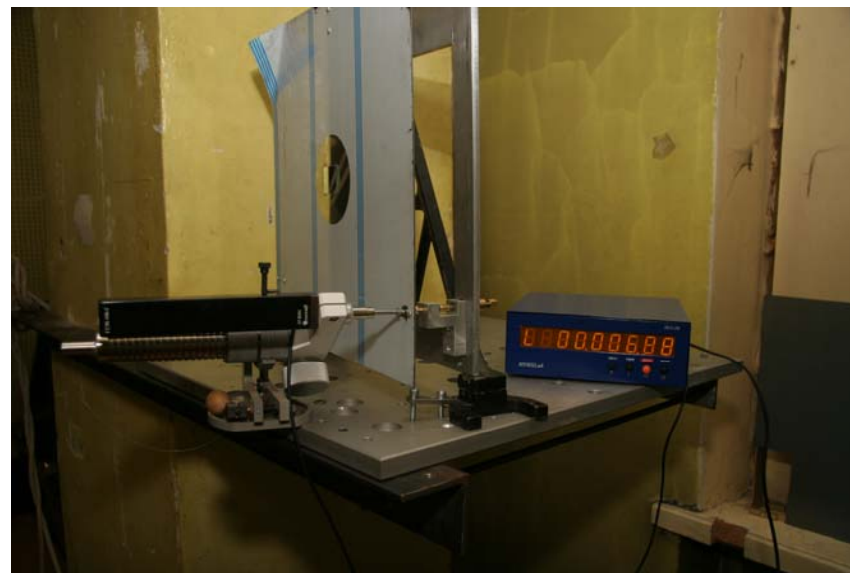
Плоское зеркало с механизмом закрепления и голографическая линейка
