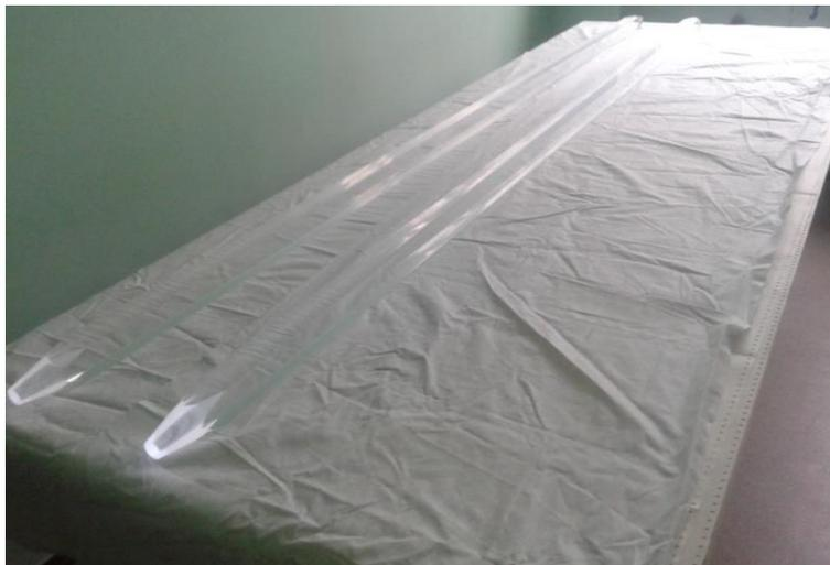
Два сцинтилляционных бруска
