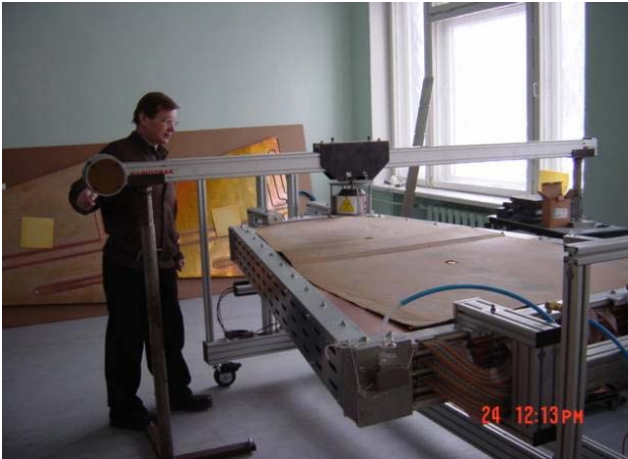
Рис. 3. Мюонная камера на стенде \mu -излучения.
