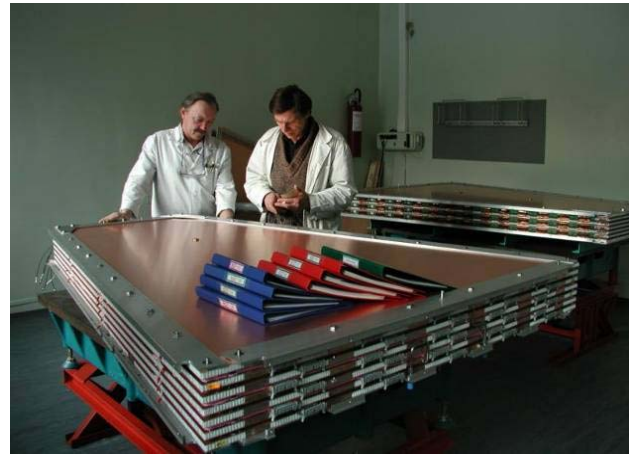
Рис. 4. Мюонная камера, готовая к установке электроники.
