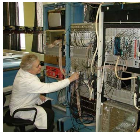
Рис. 6. Завершающие испытания мюонных камер на стенде космических лучей.
