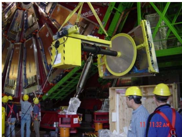
Рис. 11. Установка мюонной камеры на железный диск ярма магнита.
