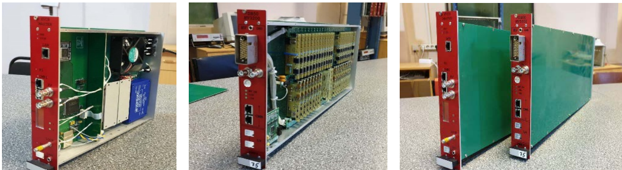
Fig. 2. Module: a – HVCB–MASTER; b – DB50; c – HVPS
