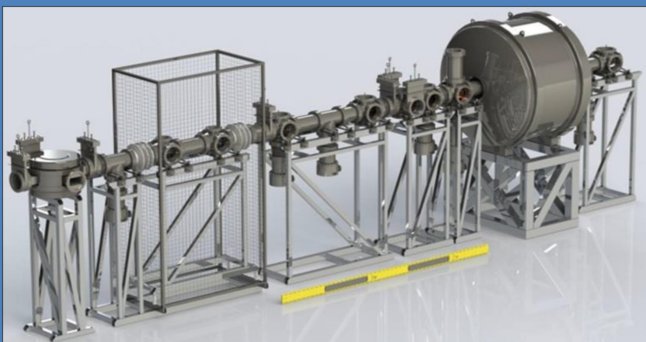
Масс-спектрометрический комплекс «ПИТРАП» на пучке выделенных масс-сепаратором «ИРИНА» изотопов позволит измерять массы экзотических ядер с точностью не хуже нескольких кэВ.
