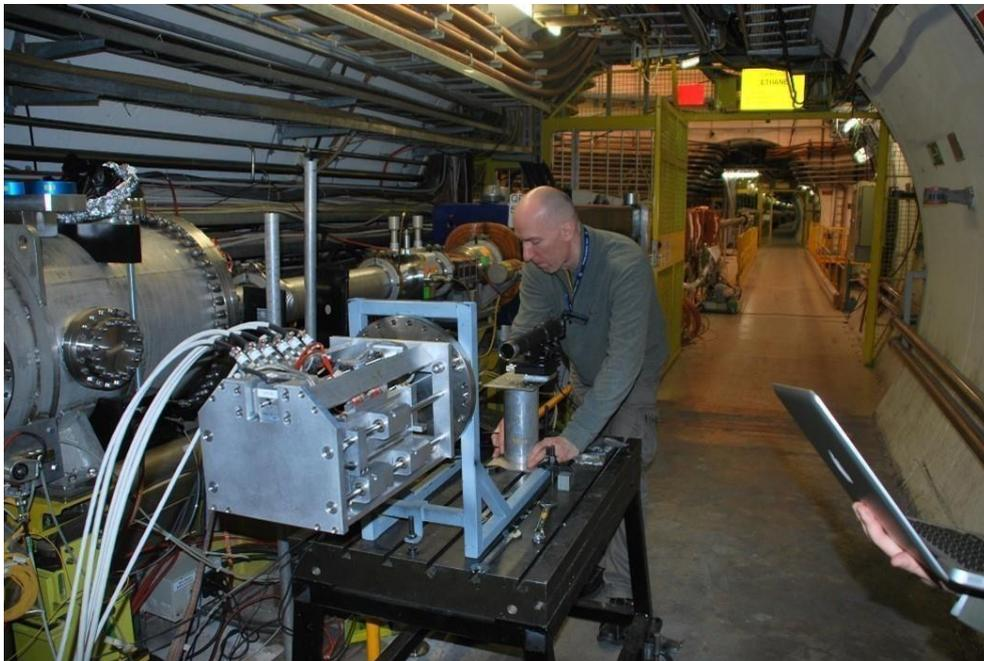
Ю.А.Гавриков в момент настройки гониометра с кристаллом в туннеле ускорителя ЦЕРН.
